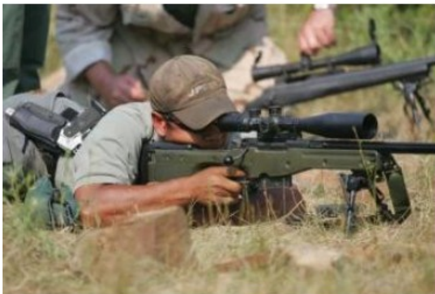
Прицел Nightforce 3.5-15x50mm NPR2 с мультиповоротом, цена клика 10MOA и 0.25MOA , на винтовке AI-AWM. Фотография Frankie Icenogle использована с его разрешения.
